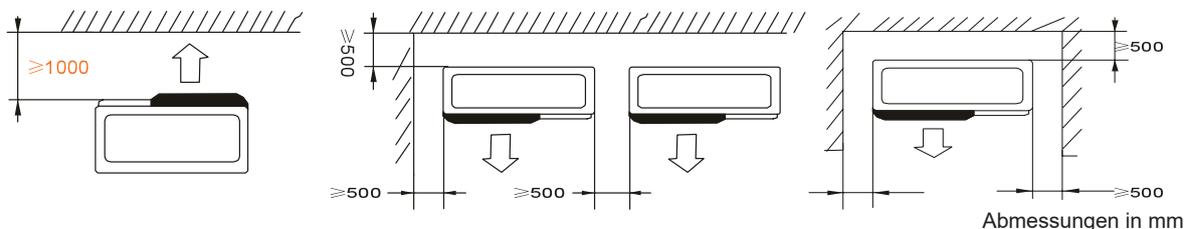
**Platzieren Sie keine Gegenstände in weniger als 1 Meter Entfernung vor der Wärmepumpe. Lassen Sie seitlich und hinter der Wärmepumpe einen Sicherheitsabstand von 50 cm.**
