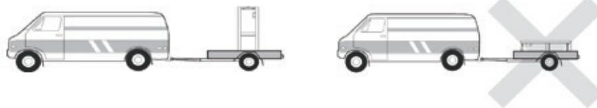
Das Gerät muss stets in senkrechter Position auf einer Palette sowie in der Originalverpackung gelagert und transportiert werden. Wird das Gerät in waagerechter Position abgestellt oder transportiert, warten Sie bitte mindestens 24 Stunden, bevor Sie es einschalten.
